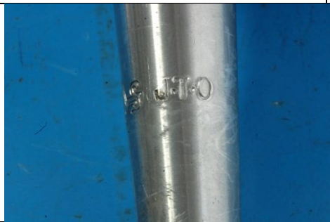
Moyeu cannelé et tube conique servant d'entretoise entre les 2 roulements. Ce tube est fabriqué en roulé puis soudé (déjà en 1930 !!!).
