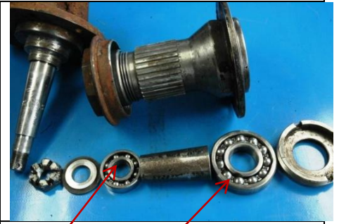
Petit roulement vers l'extérieur véhicule, gros roulement vers l'intérieur véhicule.
