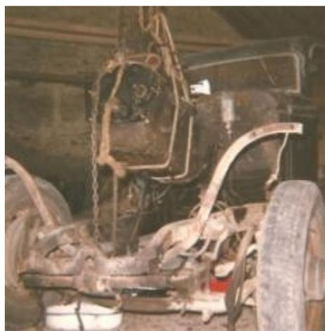
Première tentative avec une macération de gazole dans chaque cylindre, sans aucune efficacité après plusieurs semaines, il faut donc investiguer plus en profondeur. Dépose du carter, embiellage...et découverte du motif de l'arrêt de la voiture. Le fourreau de vis à huile a tourné sur lui-même et sa collerette est venue s'enficher dans la roue d'entraînement de l'arbre à excentrique. La solution passe par la destruction « déjà bien entamée » du fourreau. En mécanique les efforts devant toujours
